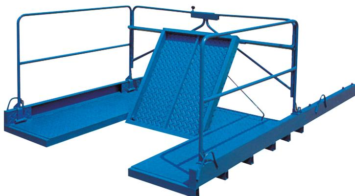
Plataforma de descarga en planta modelo CON TRAMPILLA. Esta Plataforma lleva una trampilla abatible, lo que permite su instalación en configuración vertical. La trampilla abatible sirve para el paso del cable de la grúa. Se deben utilizar dejando todas las trampillas levantadas y bajando únicamente la correspondiente a la planta en donde se va a utilizar.
