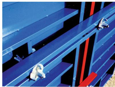
Se aconseja utilizar vigas rigidizadoras cuando se someta el encofrado a grandes presiones de hormigonado. La varilla diwidag atraviesa los paneles y las vigas rigidizadoras para roscar las tuercas sobre estas, haciendo que soporten la presión del hormigón los tres elementos.
