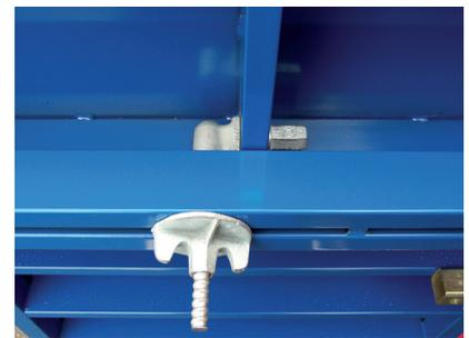
Las vigas rigidizadoras se quedan fijadas a los paneles mediante el herraje sujeción viga y dos tuercas, sin necesidad de desmontarlas cada vez que se desencofra.
