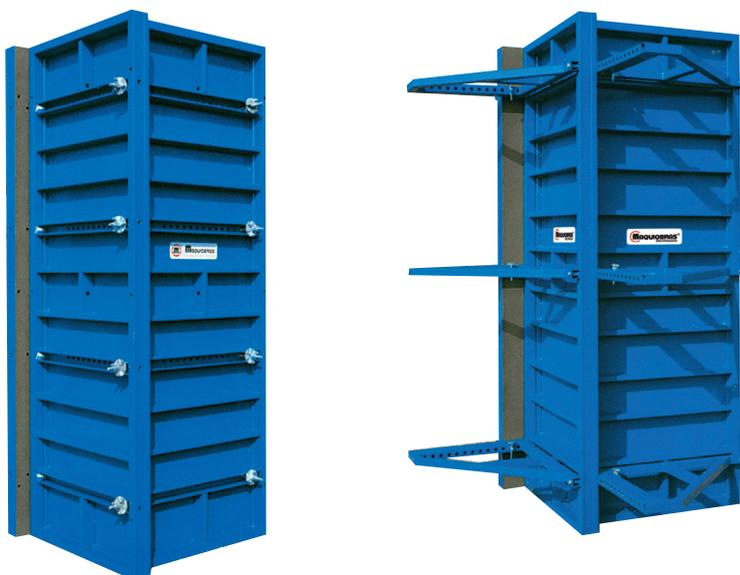
Sobre demanda, nuestra fabricación nos permite hacer una serie de taladros en los paneles para regular la medida de los pilares. Mediante los herrajes cierre pilar pasados por dichos taladros y las tuercas de plato fijo cerramos totalmente el pilar.
